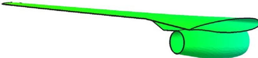
Рис. 4. Крыло самолета DLR F6 с выявленными характерными кривыми (выделены жирными линиями)
