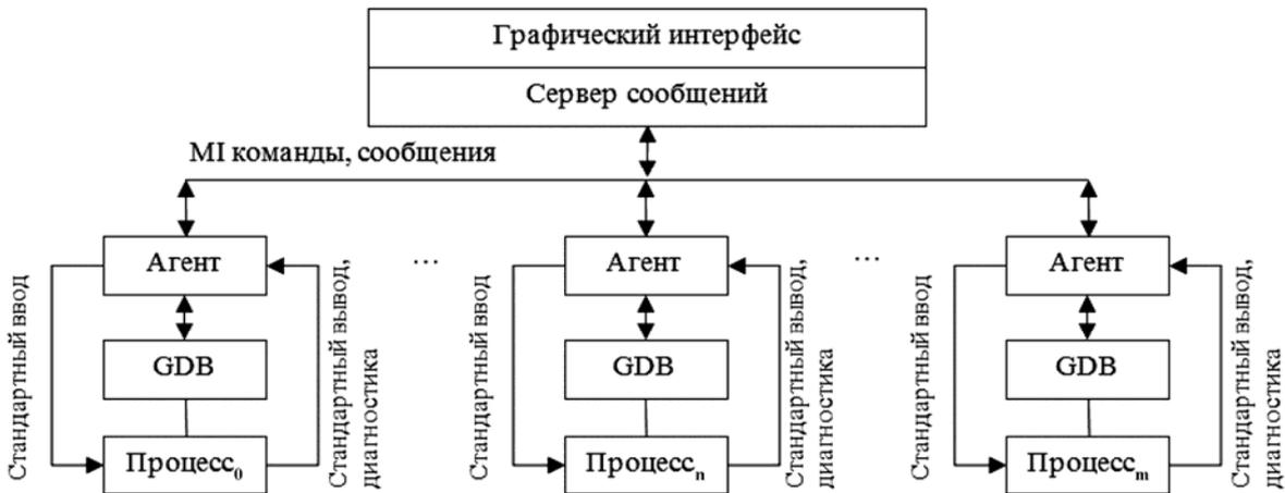
Рис. 1. Схема отладчика PD
