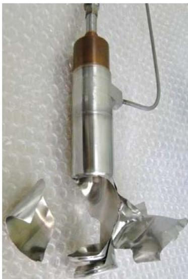
Рис. 4. Макет № 1 после испытаний на несущую способность
