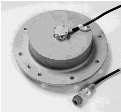
Рис. 1. Внешний вид бортовой антенны
