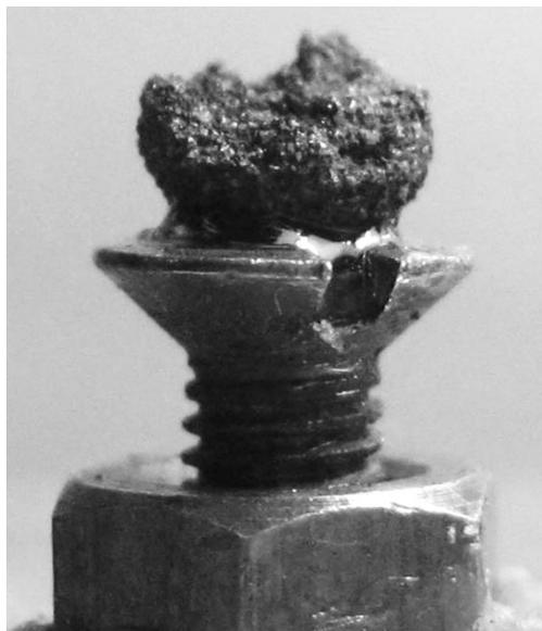
Рис. 17. Остатки шарового макета после пяти выстрелов при пятне фокусировки радиусом 160 мкм и полной энергии  $E = 51,8$  Дж
