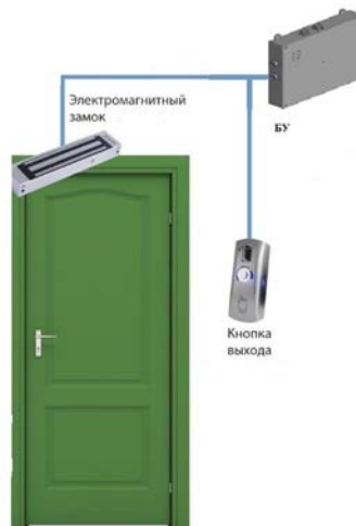
Рис. 9. Схема подключения электромагнитного замка к БУ
