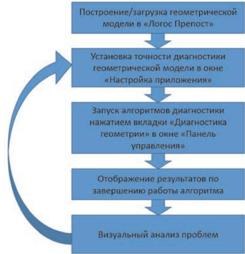
Рис. 10. Типовой сценарий взаимодействия пользователя со средствами диагностики геометрии
