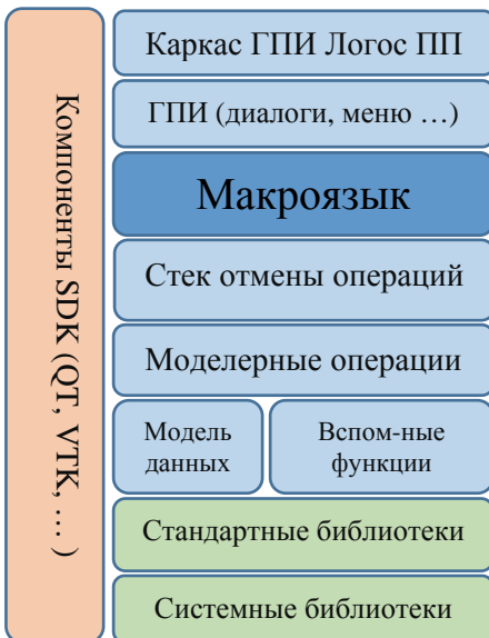
Рис. 11. Место подсистемы макроязыка, реализующего средства макроязыка в компоненте ЛОГОС-ПРЕПОСТ
