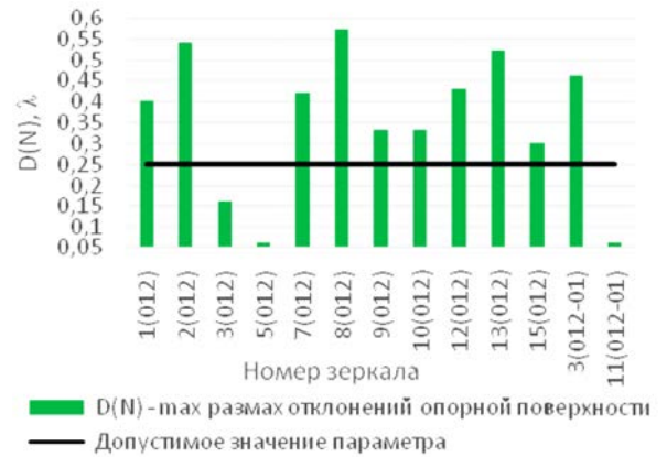
Рис. 11. Максимальный размах отклонений волнового фронта при контроле зеркал транспортировочных в I пространственном диапазоне на отражение от опорной поверхности
