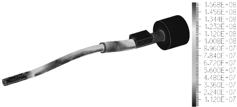
Рис. 8. Распределение эквивалентных напряжений в момент удара (40 МДж) (Па)
