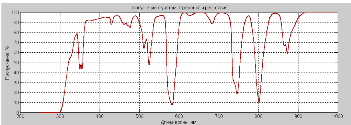
Рис. 6. Пропускание T'(\lambda) N31 с поправкой на коэффициент отражения от поверхностей (толщина образца 3,95 мм)
