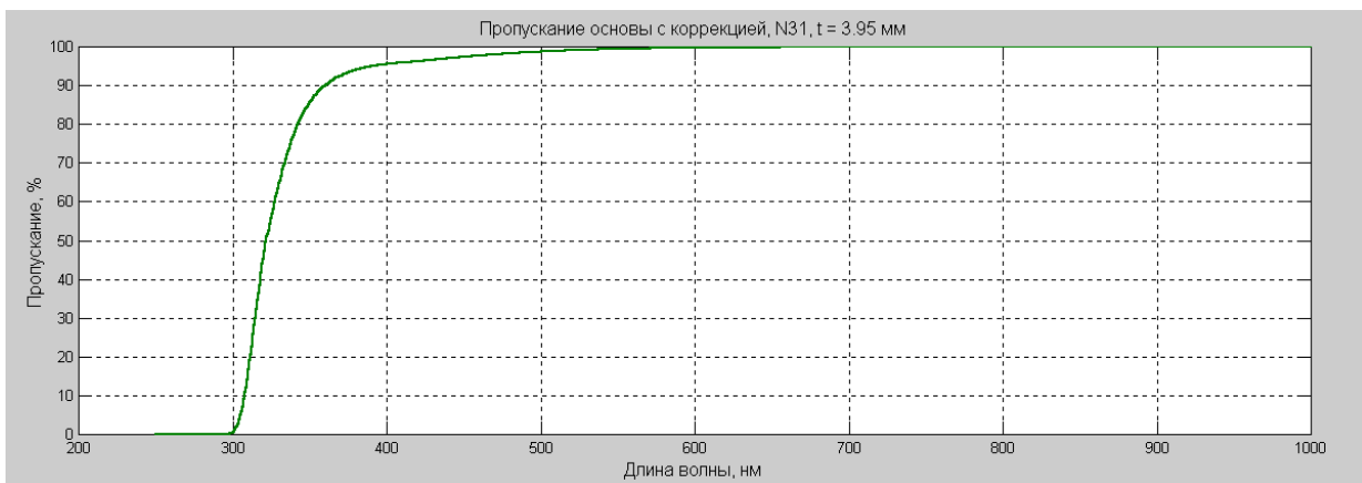
Рис. 7. Пропускание стеклообразующей основы T_0(\lambda) образца N31 толщиной 3,95 мм;
