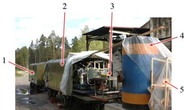
Рис. 2. Фотография одноракурсного трехимпульсного мобильного рентгенографического комплекса: 1 – модуль импульсного питания электромагнита бетатрона, 2 – ускорительный модуль, 3 – система коллимации рентгеновских лучей, 4 – ВЗК, 5 – система регистрации теневых изображений
