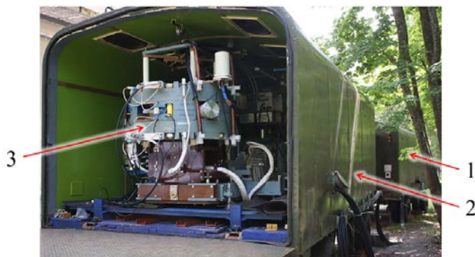
Рис. 3. Фотографии одноракурсного трехимпульсного МЦУ: 1 – фургон модуля импульсного питания электромагнита бетатрона, 2 – фургон ускорительного модуля, 3 – бетатрон типа БИМ
