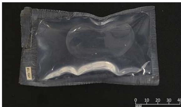
Рис. 2. Источник микропотока мешкового типа
