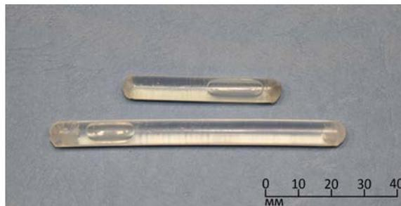
Рис. 1. Источники микропотока на основе трубок
