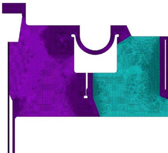
Рис. 6. Конечно-элементная 2-D модели тора
