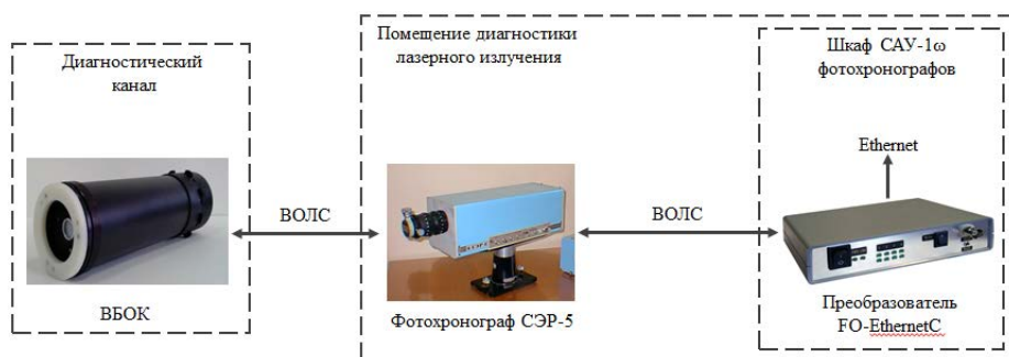
Рис. 12. Структурная схема системы регистрации временных параметров и исследования глубокого профиля лазерного излучения
