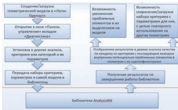
Рис. 1. Схема работы со средствами анализа качества геометрии
