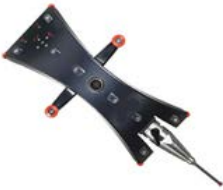
Рис. 4. Устройство для съемки скрытых точек
