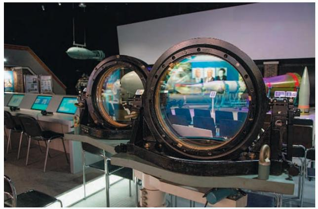
*Имитатор насыщающегося поглотителя 12-канальной лазерной установки «Искра-5»*
