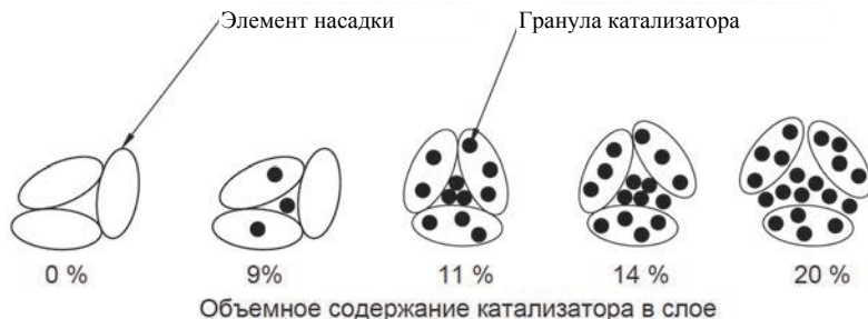
Рис. 6. Визуализация изменения решетки нерегулярной насадки с изменением объемной доли катализатора
