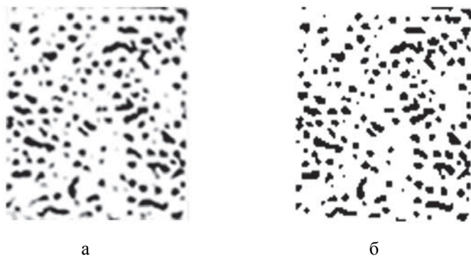
Рис. 2. Результаты сегментации МСКТ изображений для случая чистого насадочного слоя: а – исходное изображение, б – сегментированное изображение
