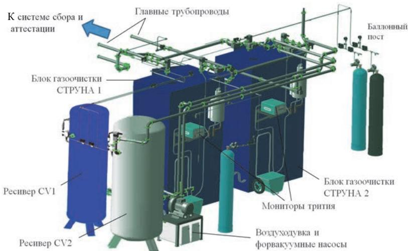
Рис. 3. Вид ТОСУ-1 (система очистки комплекса «Фабрика мишеней»)
