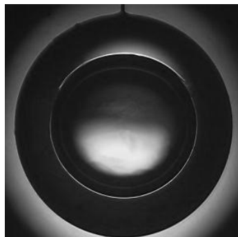
Рис. 2. Криогенный слой дейтерия в сферической оболочке
