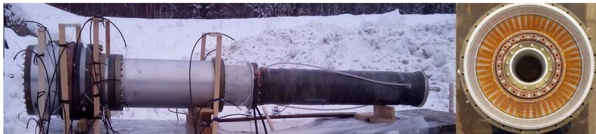
Рис. 2. Внешний вид экспериментального устройства (максимальный диаметр 0,63 м; длина – 3,5 м) и ФЭРТ в виде «змейки»
