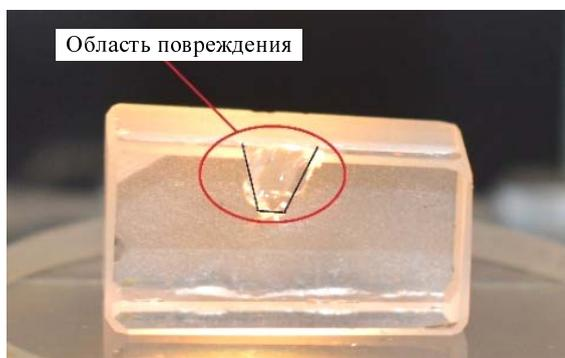
Рис. 5. Характер повреждения оптического элемента
