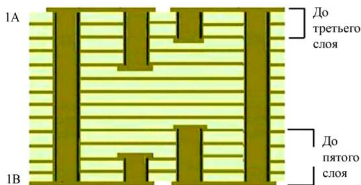
Рис. 1. Межслойные переходы по технологии поэтапного прессования
