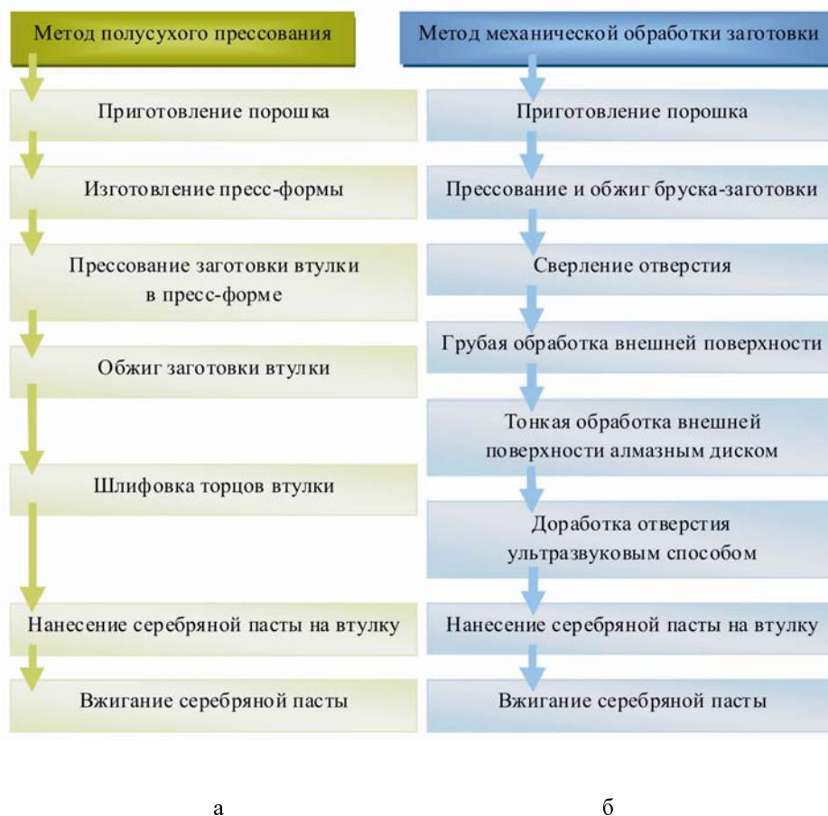
Рис. 2. Схема технологических маршрутов изготовления коаксиального керамического резонатора методами полусухого прессования (а) и механической обработки (б) бруска заготовки
