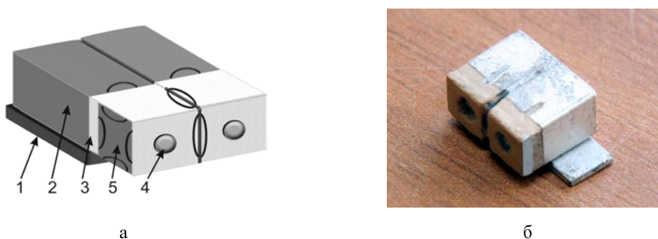
Рис. 7. Конструкция (а) и внешний вид (б) полосно-пропускающего фильтра с повышенным уровнем пропускаемой мощности (полукруглыми областями выделены места выборки металлизации при регулировке частоты и связей между резонаторами и внешними устройствами)
