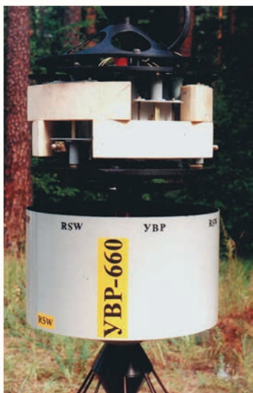
Взрывной резак УВР-660 для реза трубы изнутри. Патент RU 2204689. Бронзовая медаль на Женевском салоне, 2008 г.
