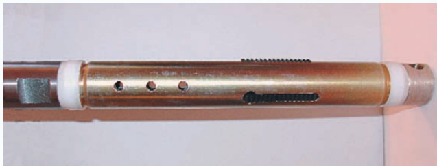
Вид газоввода для пассивовки с узлом фиксации клинового типа
