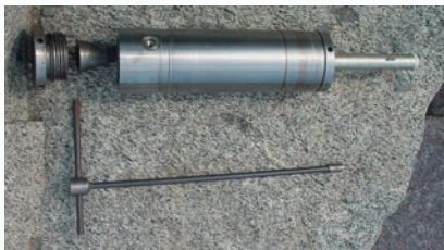
ВГД со специальным ключом (а) и газоввод с узлом фиксации клинового типа (б)
