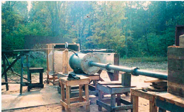
Специализированное устройство (ударная труба) в сборе перед опытом
