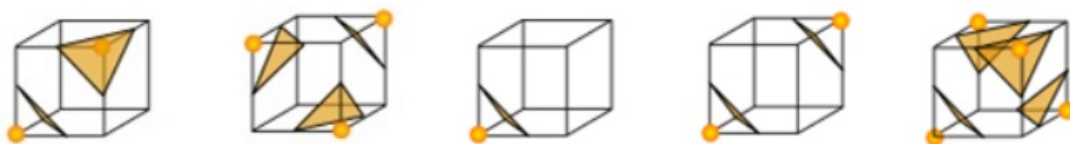
Рис. 6. Пример обобщения случаев пересечения шаблонных ячеек с треугольниками для единообразного удаления малых ребер
