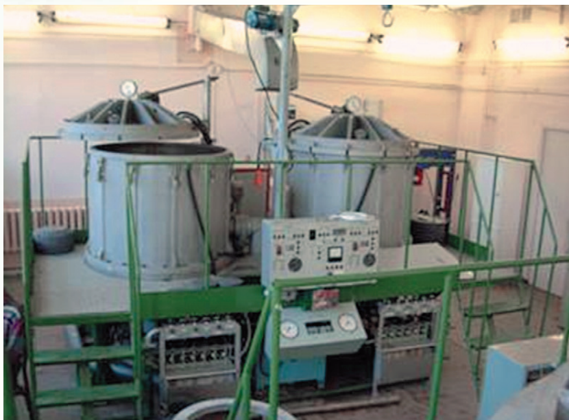
Установка для высокотемпературного горячего прессования броневой керамики на основе карбида бора
