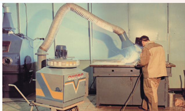
Передвижная фильтровентиляционная установка для тонкой очистки газов, авторское свидетельство № 1757160
