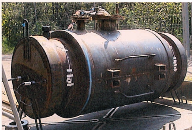
Общий вид ремонтного устройства труб большого диаметра без их вывода из эксплуатации, патент № 2378559
