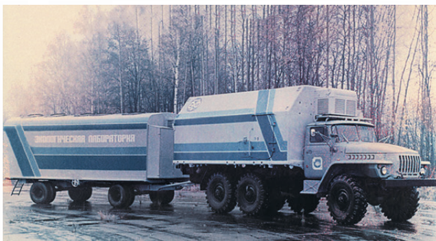
Передвижной радиационно-экологический комплекс с системой контроля окружающей среды
