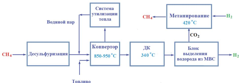
Рис. 1. Принципиальная схема процесса паровой конверсии метана
