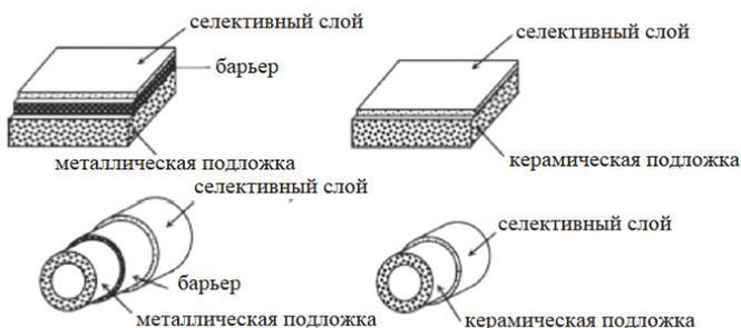
Рис. 12. Структура композитной мембраны
