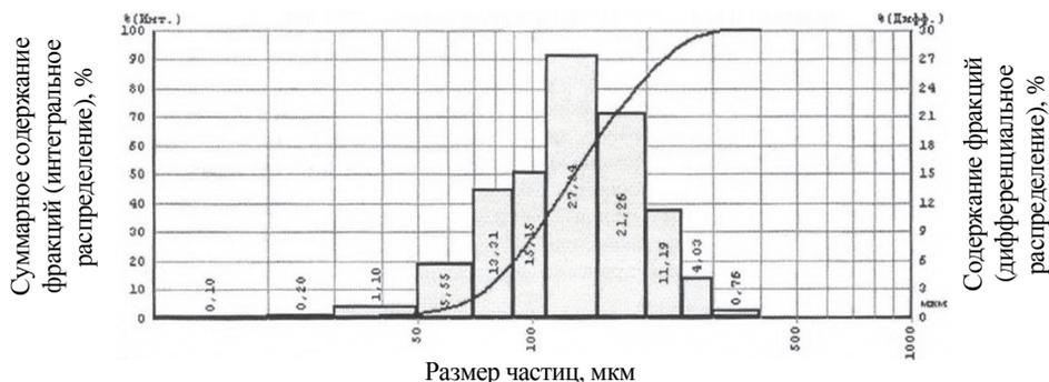
Рис. 2. Поверхностное распределение размеров частиц алюмосиликатных микросфер
