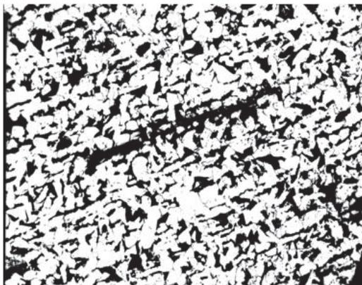
Рис. 4. Трещины в стенке трубы (сталь 17Г1С после эксплуатации 6 лет)
