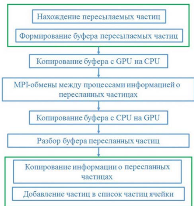
Рис. 2. Алгоритм пересылки частиц на другой MPI-процесс
