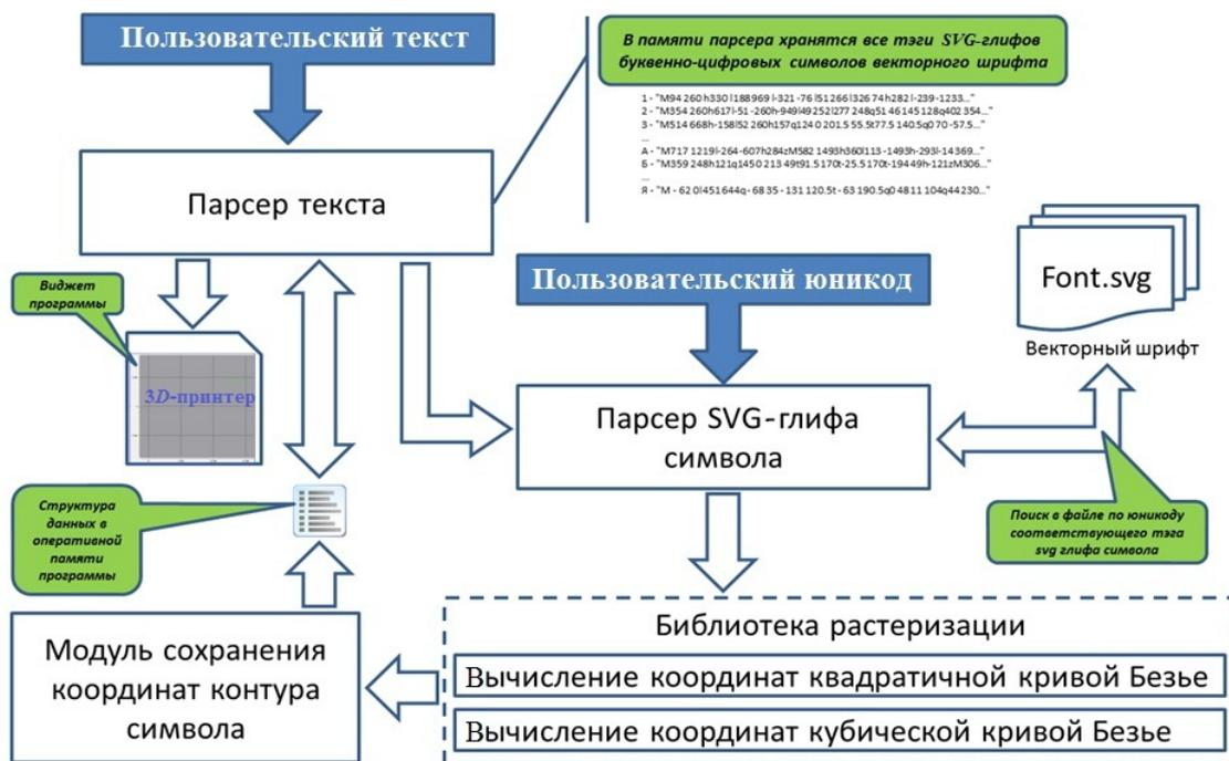
Рис. 7. Схема работы программ поддержки векторных шрифтов в модуле задания 2D-контуров
