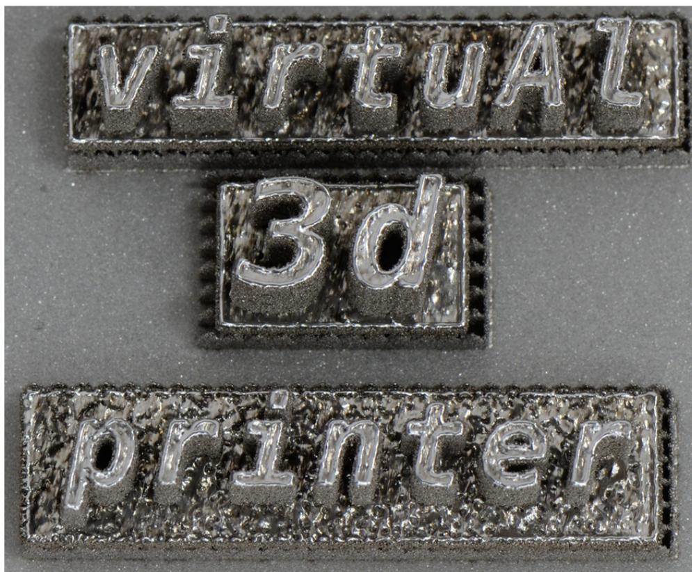
Рис. 15. Фотография выполненной векторным шрифтом надписи, полученной селективным лазерным спеканием металлической порошковой смеси
