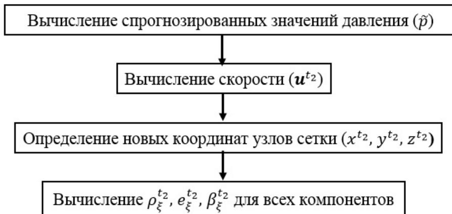
Рис. 4. Последовательность вычислений на лагранжевом этапе газодинамики
