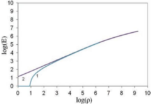
Рис. 1. Зависимость  $\log(E)$  от  $\log(\rho)$  для водорода: 1 – сумма кинетической и потенциальной энергии, 2 – кинетическая энергия. Энергия в электронвольтах, плотность в единицах  $\text{г}\cdot\text{см}^{-3}$
