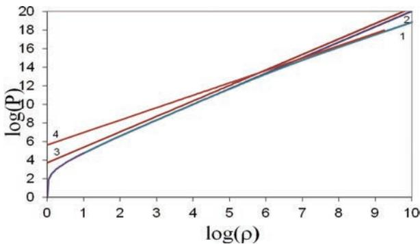
Рис. 2. Зависимость  $\log(P)$  от  $\log(\rho)$  в водороде: 1 – расчет давления в релятивистском приближении, 2 – нерелятивистский расчет, 3 – давление в нерелятивистском вырожденном электронном газе, 4 – давление в ультра-релятивистском вырожденном электронном газе. Давление в ГПа, плотность в единицах  $\text{г}\cdot\text{см}^{-3}$ . Релятивистское приближение отличается от нерелятивистского, начиная с плотности  $10^6 \text{ г}\cdot\text{см}^{-3}$
