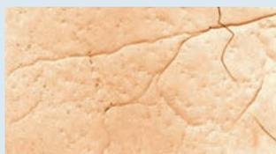
Электронно-микроскопическая фотография микропор и трещин, обнаруженных в кристаллах октогена ( $\times 11000$ )
