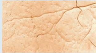
Электронно-микроскопическая фотография микропор и трещин, обнаруженных в кристаллах октогена (×11000)
