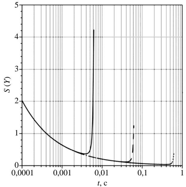
Рис. 4. Для разных скоростей ИС относительное СКО суммарного числа делений, происходящих в течение переходного процесса: .....  $v_{\text{max}} = 0,5$  м/с, - - -  $v_{\text{max}} = 5$  м/с, —  $v_{\text{max}} = 50$  м/с
