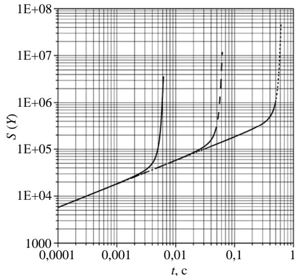
Рис. 5. Для разных скоростей ИС СКО суммарного числа делений, происходящих в течение переходного процесса: .....  $v_{\text{max}} = 0,5$  м/с, - - -  $v_{\text{max}} = 5$  м/с, —  $v_{\text{max}} = 50$  м/с
