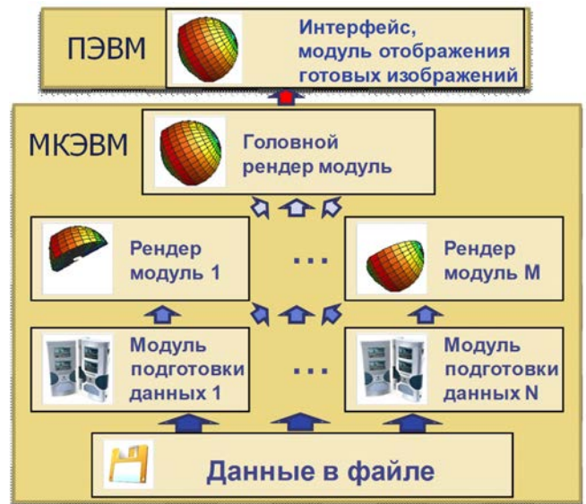
Рис. 4. Общая схема работы ScientificView в параллельном режиме
