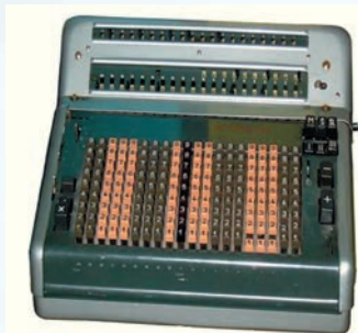
Рис. 2. Настольная электромеханическая немецкая клавишная машинка «Мерседес». Скорость вычисления – менее 1 оп./с
