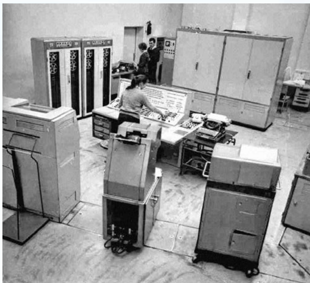
Рис. 6. ЭВМ «БЭСМ-4» (20 тыс. оп./с) – это ЭВМ второго (полупроводникового) поколения, 1966–1975 гг.
