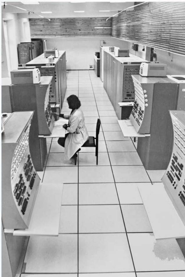
Рис. 8. ЭВМ третьего (на интегральных схемах) поколения единой серии стран СЭВ – ЕС 1050–ЕС 1066 (от 0,5 до 5 млн. оп./с), 1978–2000 гг.
