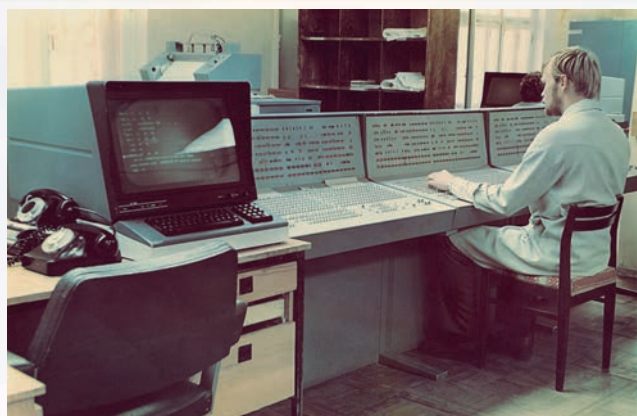
Рис. 9. ЭВМ третьего (на интегральных схемах) поколения серии «Эльбрус-1К2», 1980–2000 гг.
