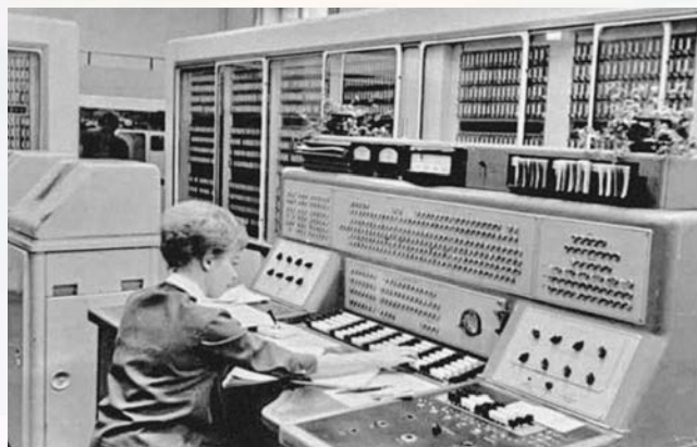
Рис. 5. ЭВМ «М-20» первого (лампового) поколения, 1961–1969 гг.
