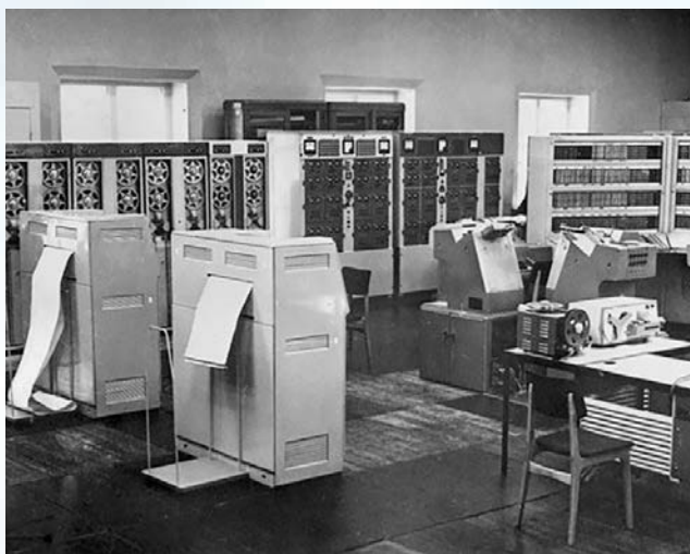
Рис. 7. ЭВМ второго (полупроводникового) поколения «БЭСМ-6» (1 млн. оп./с), 1967–1991 гг.
