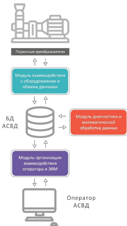
Рис. 1. Структурная схема программной части системы вибродиагностики
