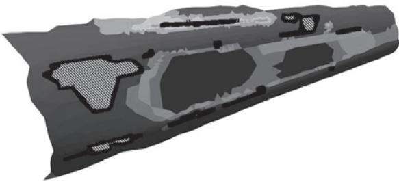
Рис. 7. Выделенные области несоответствия размеров и наложенные области неустойчивой кривизны
