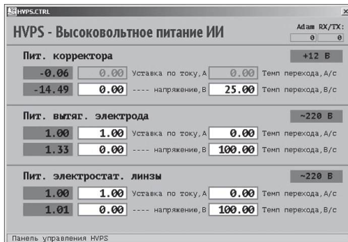
Рис. 5. Графический интерфейс программного модуля управления высоковольтными источниками питания
