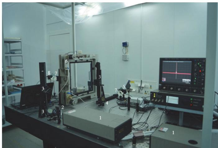
Рис. 3. Стенд для измерения угла синхронизма: 1 – лазер с  $\lambda = 1053$  нм, 2 – полупрозрачная пластина, 3 – зеркала, 4 – фокусирующая линза, 5, 8 – измерители энергии, 6 – моторизованная оправа, 7 – светофильтр
