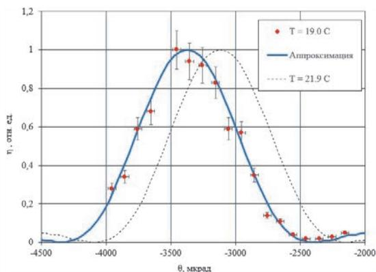
Рис. 5. Зависимости относительной эффективности преобразования от угла отклонения от положения синхронизма, полученные для двух значений температуры кристалла
