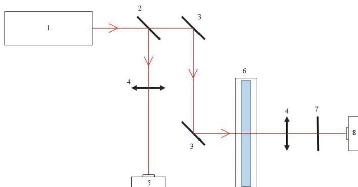
Рис. 2. Оптическая схема стенда для измерения угла синхронизма: 1 – лазер с  $\lambda = 1053$  нм, 2 – полупрозрачная пластина, 3 – зеркала, 4 – фокусирующая линза, 5, 8 – измерители энергии, 6 – моторизованная оправа, 7 – светофильтр
