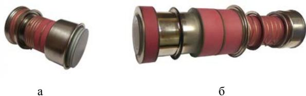
Рис. 5. Хронографические ЭОП: а – ТПО29, б – ТПО30-01, [6]
