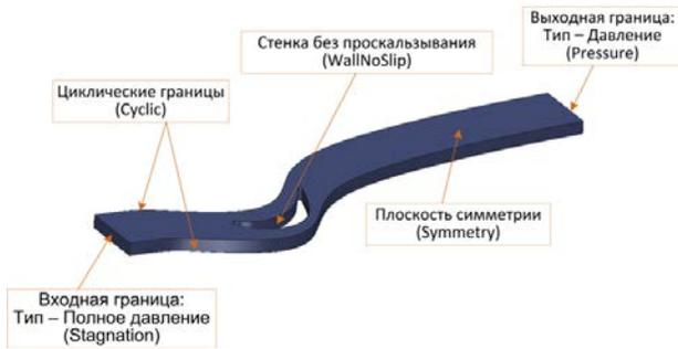
Рис. 4. Расчетная схема
