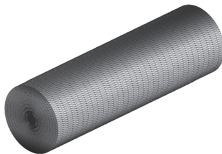
Рис. 8. Поверхностная сетка для контрольной области типа цилиндр до проведенной оптимизации алгоритма построения
