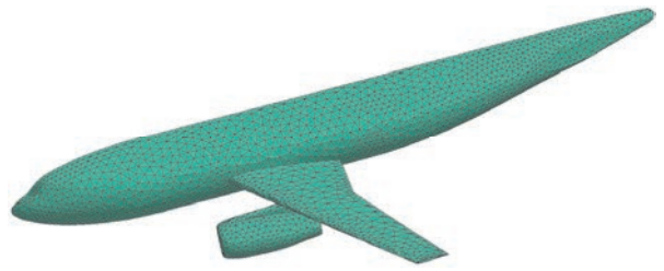
Рис. 3. Фрагмент сетки после алгоритма упрощения во второй модификации
